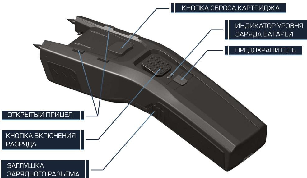
Предохранитель защищает ЭШУ АВАТАР от случайного срабатывания. Предохранитель выполнен в виде переключателя, который необходимо сдвинуть влево для разблокирования электрошокового устройства.
